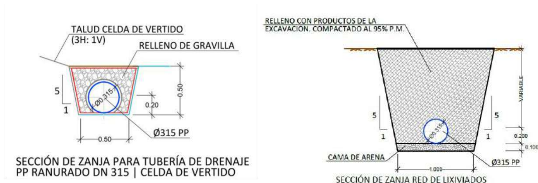
Imagen 13 Zanja tipo tubería de drenaje y de red de lixiviados
