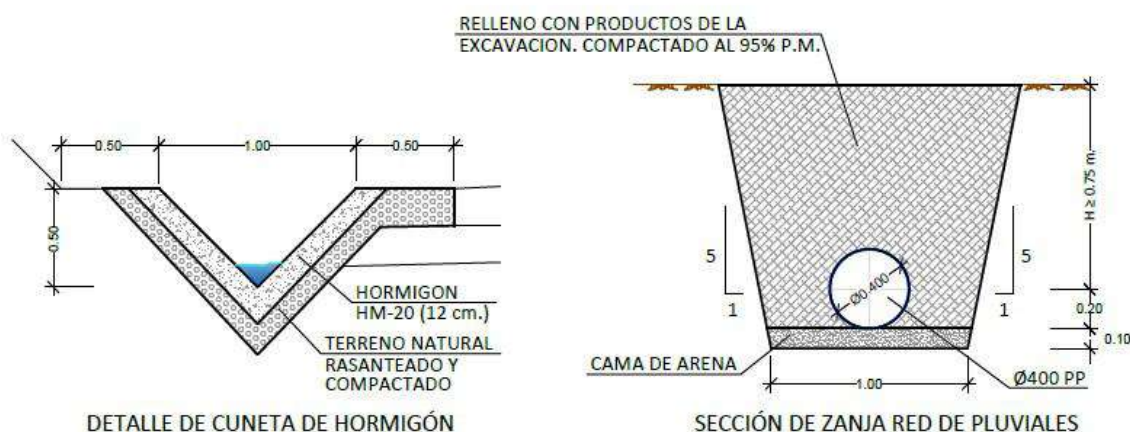
Imagen 16 Sección tipo de cuneta y zanja de colector de pluviales
